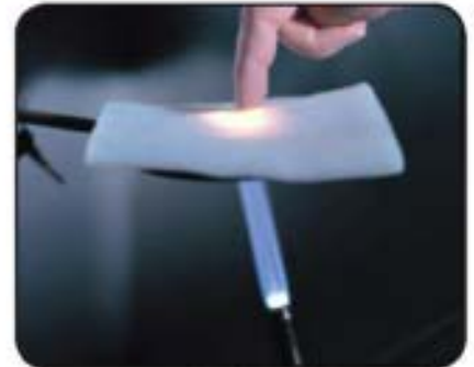
● شكل (٢) المقدرة الخارقة لهلاميات الهواء في منع انتقال حرارة شعلة ملتهبة.
